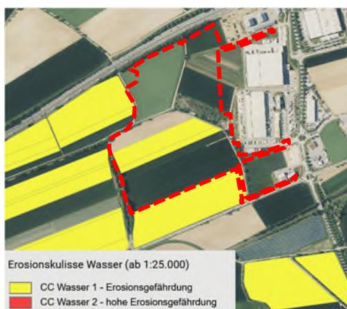
Die Ackerböden im Planungsraum sind teilweise durch Wasser erosionsgefährdet. Die Erosionsgefährdung ist nicht als hoch eingestuft. Es handelt sich dabei um zwei Flurstücke im Gewinn Wammesfeld. Das übrige Planungsgebiet weist keine Erosionsgefährdung auf.
