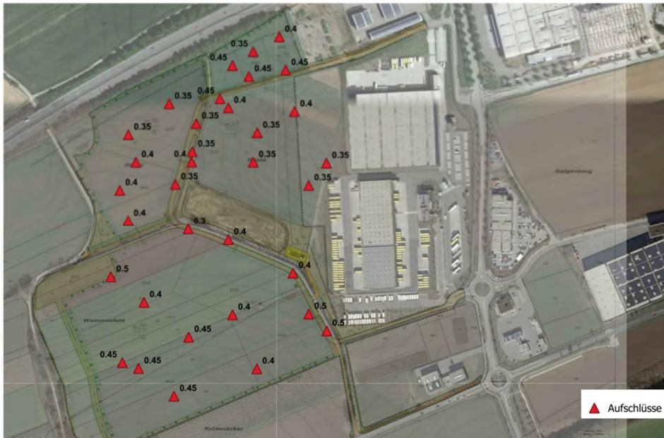
Abb.: Lageplan mit Oberbodenmächtigkeiten in [m] (Quelle GMP Geotechnik GmbH & Co. KG)
